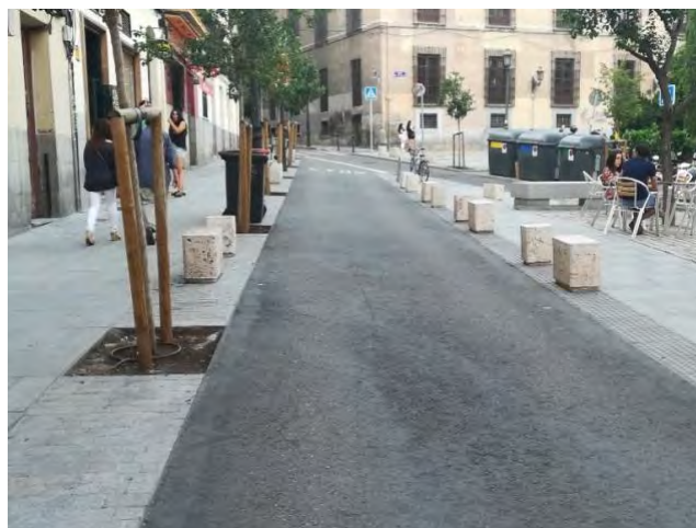
Imagen 2: Ejemplo de zona de plataforma única sin espacio de tránsito compartido entre peatones y vehículos y con delimitación del espacio de uso peatonal mediante elementos y pavimento táctil.
